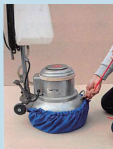
全体が締まったのを確認し付属の金具をとめて完成。
